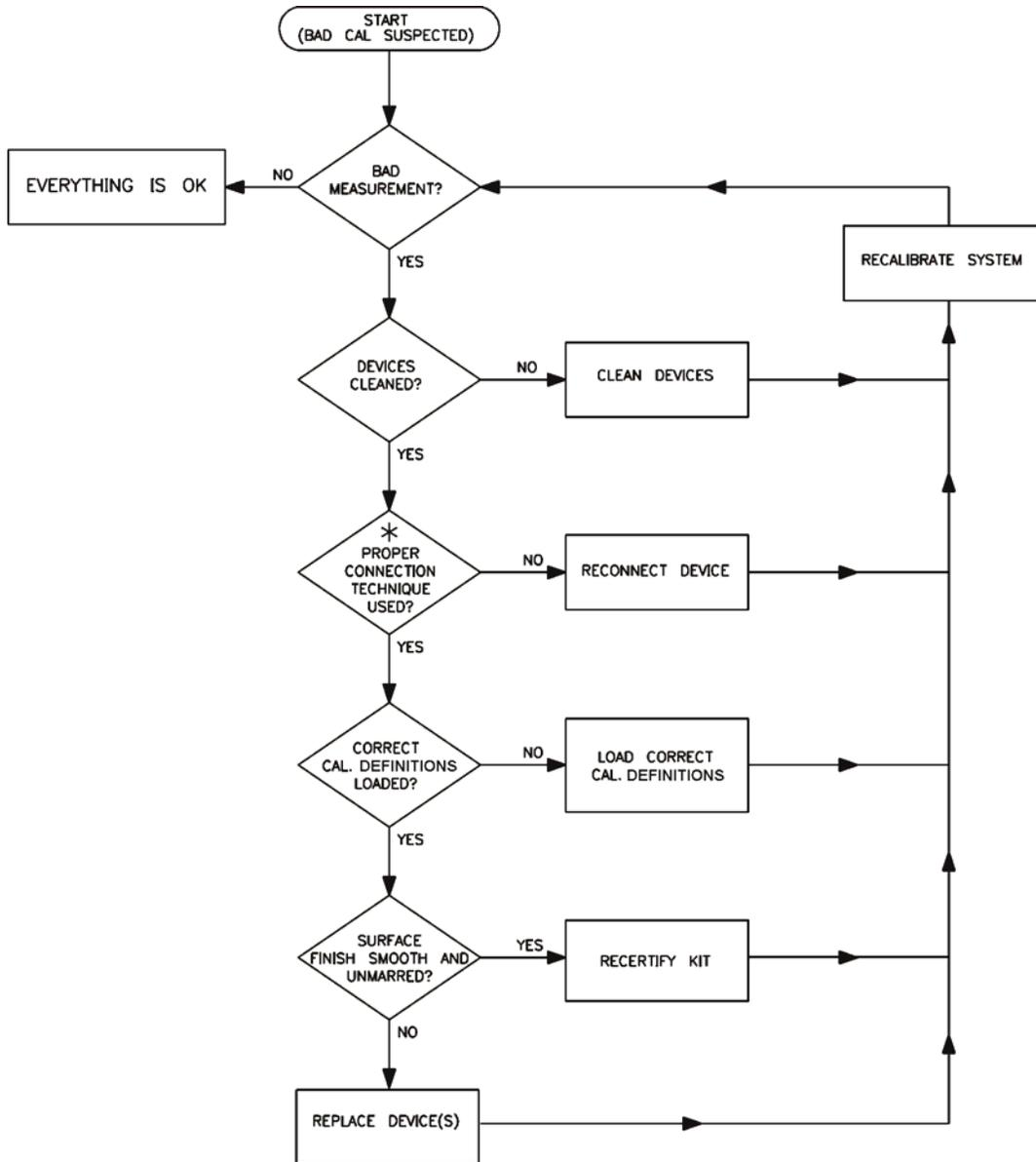
\* NO GAPS; WAVEGUIDE WALLS FLUSH;
