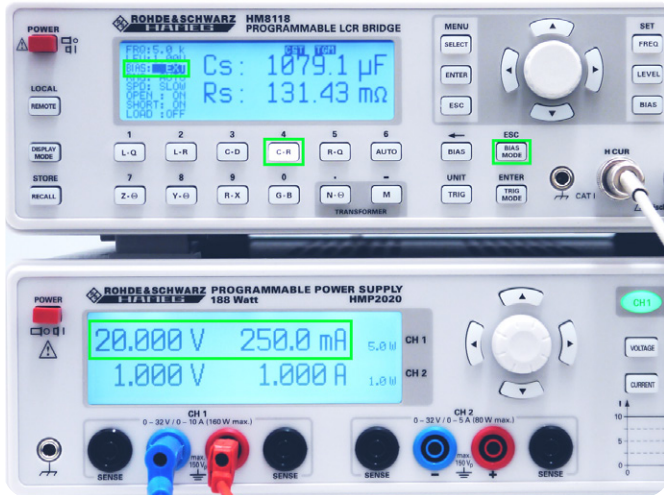
Abb. 7.5: Externe BIAS Vorspannung einstellen
