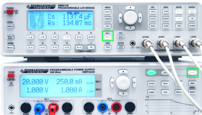
Abb. 7.6: Externe BIAS Vorspannung aktivieren
