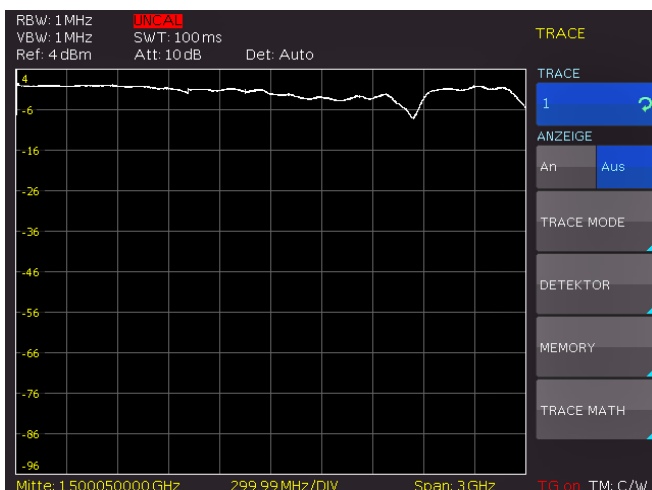
Abb. 6.8: Anzeige der gespeicherten Kurve (Show Memory)
