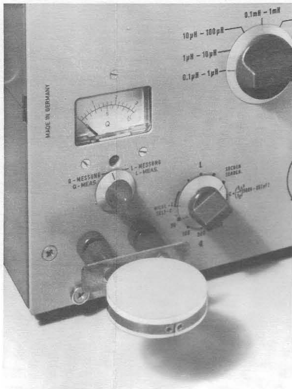
Vorrichtung zum Messen von Induktivitäten unter 100 nH. Links ohne, rechts mit Meßobjekt
