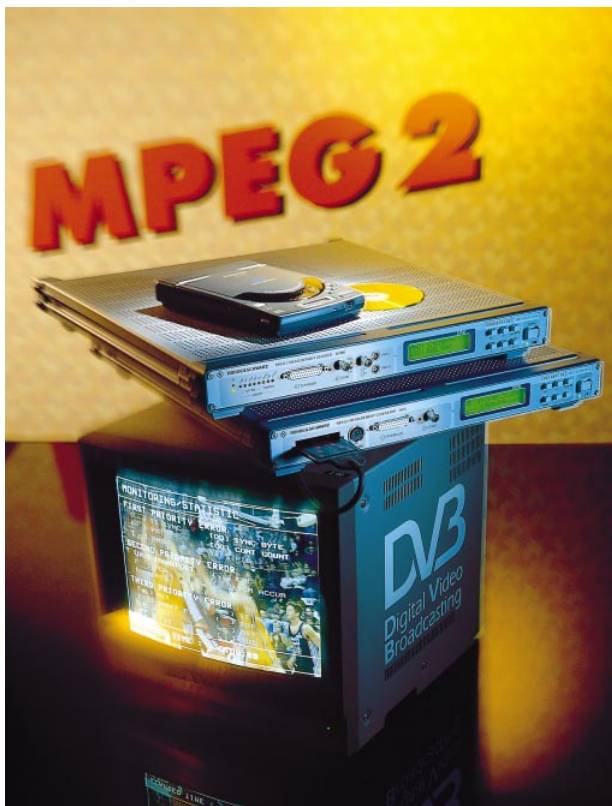
BILD 1 MPEG2-Generator DVG und -Meßde- coder DVMD sowie Fernsehmonitor mit decodiertem Bild und Menüdarstellung. Foto 42 498/1
