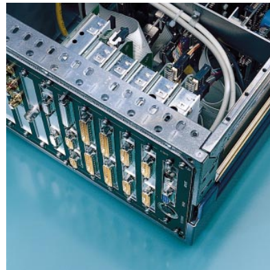
BILD 2 EMV-Filter der seriellen und parallelen Anschlüsse im Systemprozessor MERLIN GR2000X. Foto 42 568/1
