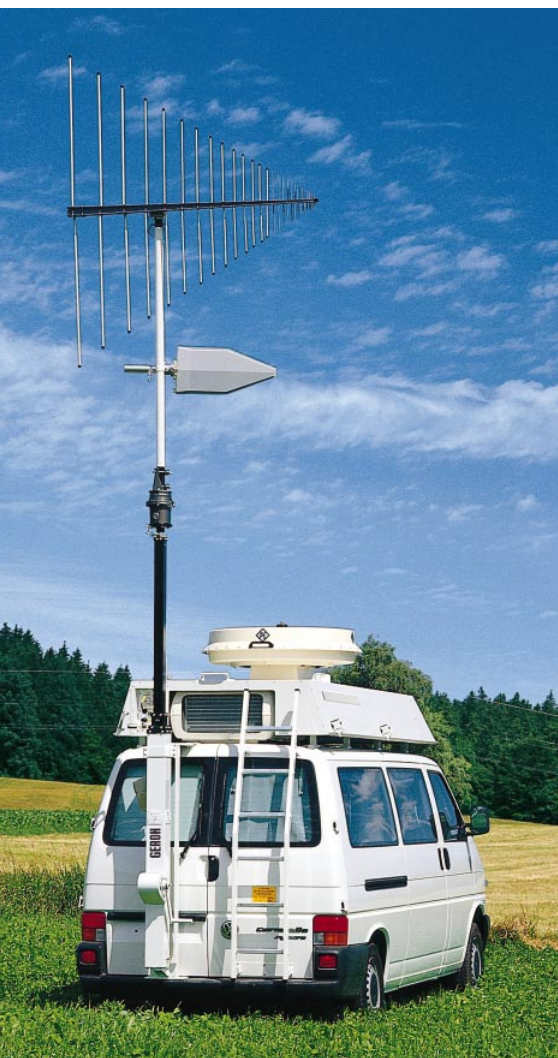
BILD 1 Peil- und Überwachungsfahrzeug mit VHF-UHF-Peiler DDF190. Mit seiner obersten Frequenz von 3 GHz spürt der DDF190 auch Störer im Bereich der neuen Funkdienste auf (z. B. GSM, PCN, PCS, WLL und GPS). Foto 42 572
