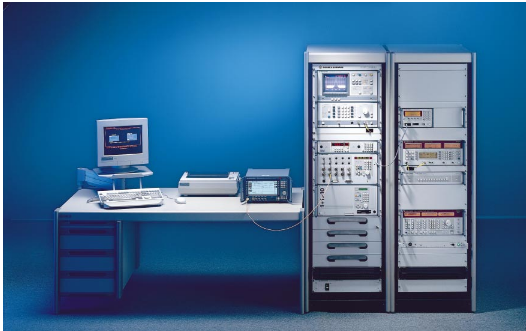
BILD 1 Kalibriersystem TS9099 für Signalgeneratoren, Meßempfänger, Sprechfunkmeßplätze und ähnliche Geräte. Foto 42 188
