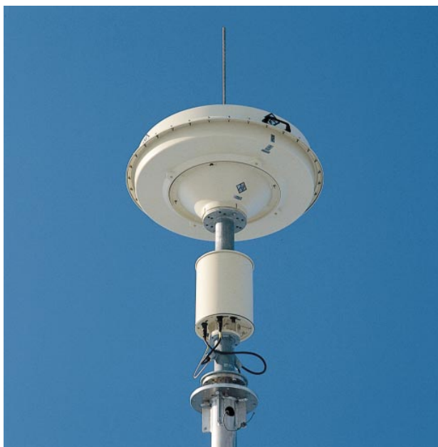
BILD 4 Antennen ADD190 (oben) und ADD071 am gemein- samen Tragmast. Foto 42 477/1
