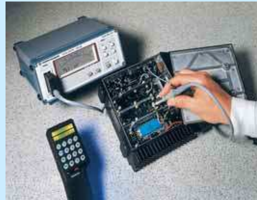
Belastungsarme Spannungsmessung mit HF-Tastkopf R&S® URV5-Z7
